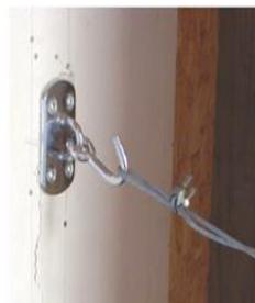
Falha observada no painel com **2,6 kN**
